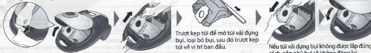
Trượt kẹp túi để mở túi vải đựng bụi, loại bỏ bụi, sau đó trượt kẹp túi về vị trí ban đầu.
